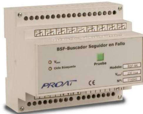
Al cabo de pocos segundos, procede a quitar el cortocircuito del primer seguidor y verificar si reaparece el fallo de aislamiento. Si no surge el fallo, lo deja funcionando y si se presenta lo vuelve a cortocircuitar. Realiza el mismo proceso con el siguiente seguidor hasta que haya realizado la prueba con todos los seguidores. Al final del ciclo quedarán cortocircuitados los seguidores que tuvieron fallo de aislamiento.
